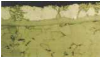
アルミ溶融メッキ鋼板 (HDA) 曲げ加工前 初期の段階の為、金属間化合物にクラックは見られない
