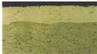
アルミ / 軟鋼 / アルミクラッド (FERAN) 材曲げ加工後 アルミと軟鋼の間の再結晶化により金属間化合物は見られない AL-Layer AISi 0.8
